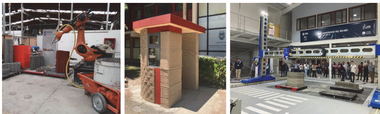
Slika 1. Oprema i prvi radovi 3D tiskane gradnje na Sveučilištu del Bío-Bío u Čileu
