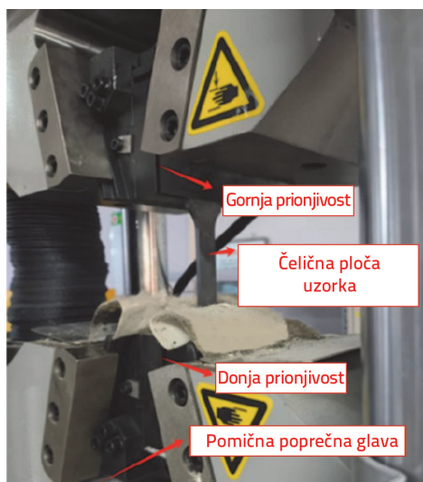
Slika 11. Ispitivanje vlačnih svojstava čelika u skladu sa standardom
