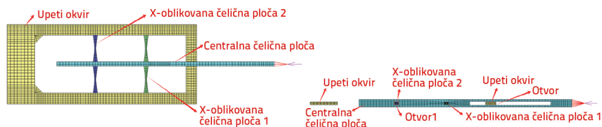
Slika 24. Model konačnih elemenata D-2
